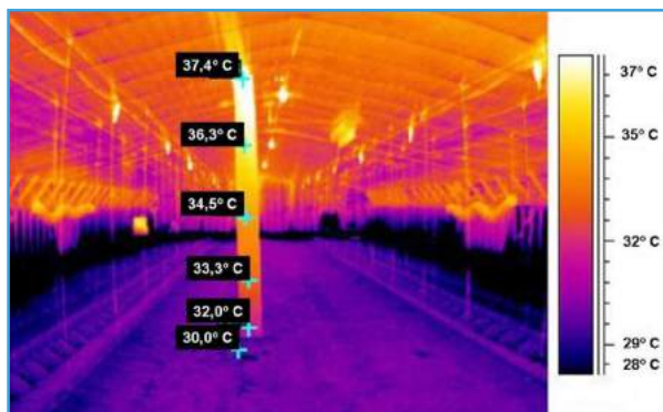
La temperatura siempre tiende a ser mayor en la medida que aumenta la altura. Hay que tener esto en cuenta en las granjas de jaulas con diferentes alturas Cortesía de M. Czarick – UGA
