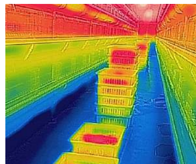
Foto termográfica. Recuerde que el suelo siempre está frío.
